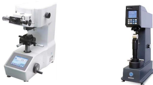
El ensayo se realiza aplicando una esfera específica con fuerza a la superficie preparada. El ancho del diámetro de la indentación especifica la dureza.
